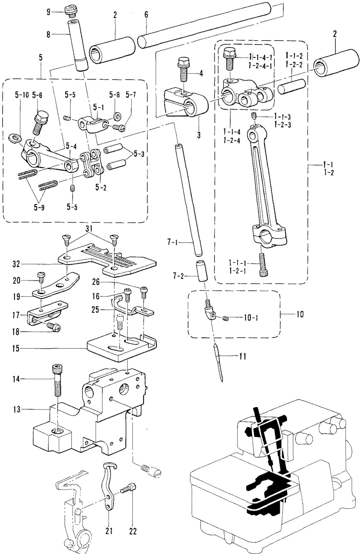
C. 針棒関係 / Needle bar mechanism / Nadelstangenvorrichtung /
