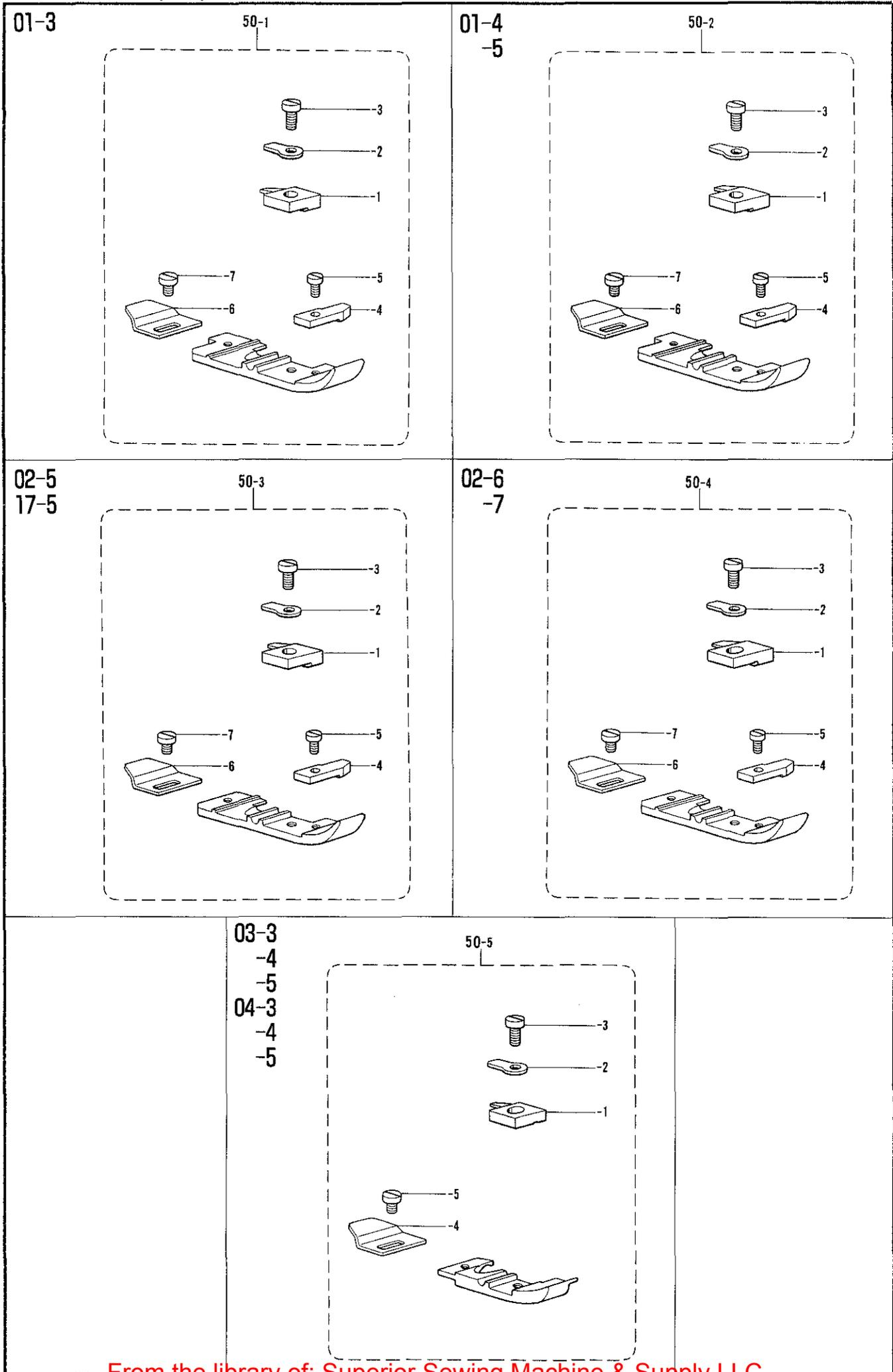
D. 押工関係/Presser foot mechanism/Stoffdrückerfuß/
