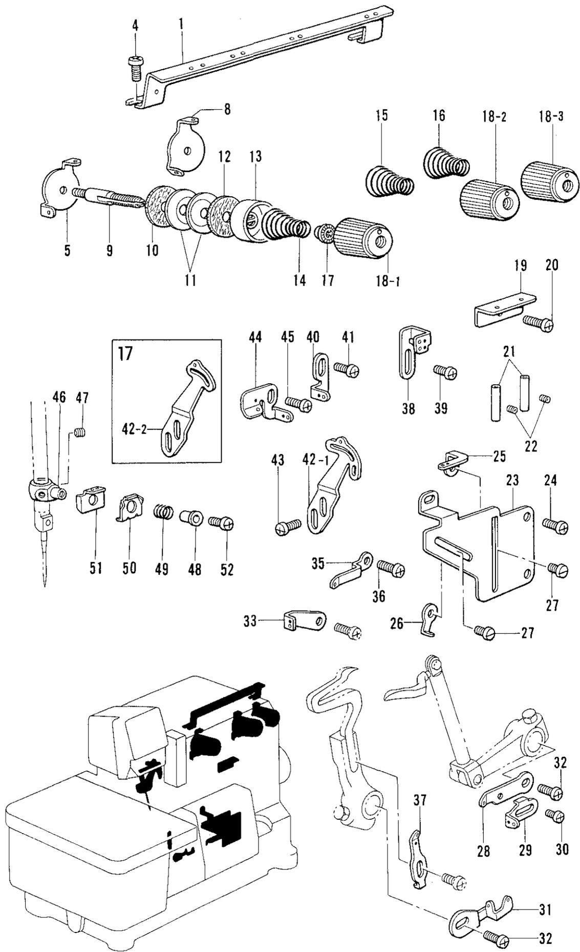
K. 糸調子関係 / Thread tension / Faderspannung /
